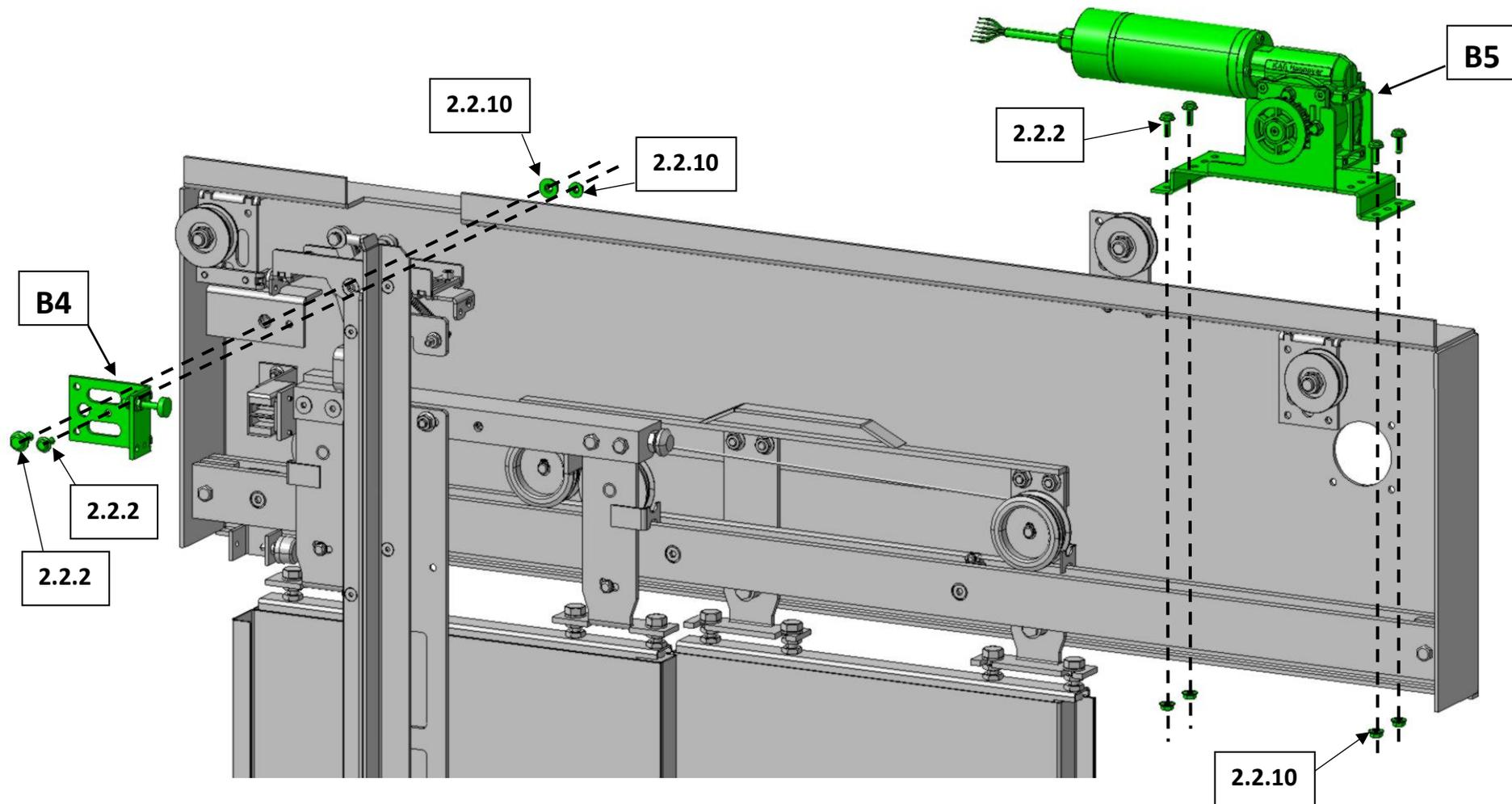
Montage: Bauteile montieren (grün dargestellt) / Installation: install components (shown in green)
