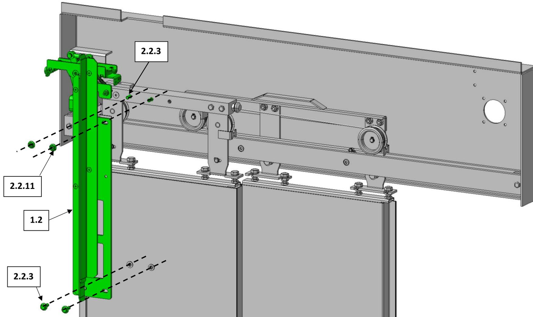
Montage: Bauteile montieren (grün dargestellt) / Installation: install components (shown in green)
