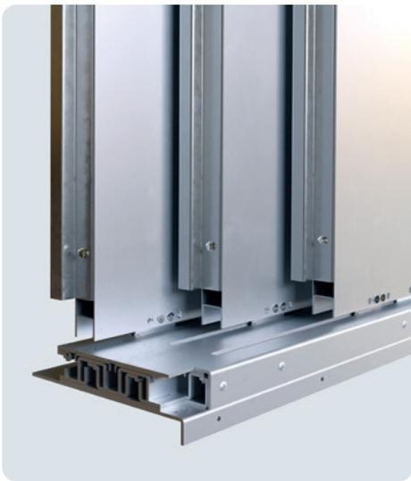
Die hoch belastbare Stahlschwelle ist immer zweigeteilt. Die Führungsnuten sind nur soweit gelasert, wie es für den Verfahrensweg der Türblätter notwendig ist. Bei geschlossenen Türblättern sind somit keine Führungsnuten sichtbar. Die maximale Radlast der Schwelle beträgt 5,0 to.
