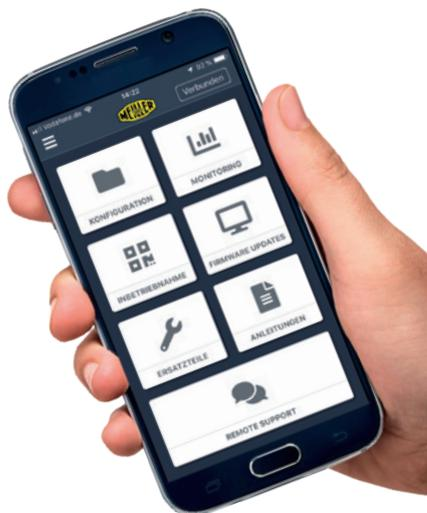
Die Inbetriebnahme der Türen erfolgt einfach und schnell per Handy-App, über definierte QR-Codes werden die Türantriebe produkt- und auftragspezifisch vor Ort konfiguriert. Fehlercodes werden in Klartext auf dem Smartphone angezeigt und machen damit eine einfache Fehleranalyse jederzeit möglich.
